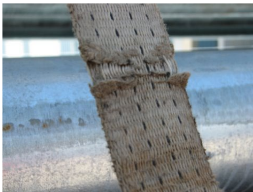
Beschadiging van verbindingen in de band. Spanband niet gebruiken.
