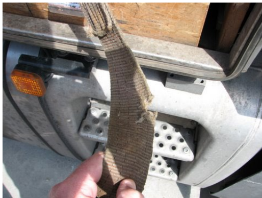
Scheur in spanband. Spanband niet gebruiken.
