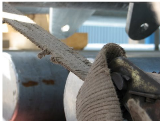
Scheur in spanband. Spanband niet te gebruiken.
